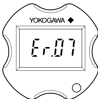
Рисунок 8.5.1. Идентификация неисправностей с помощью встроенного индикатора
