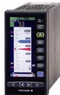
Отказобезопасный: Благодаря двойному ЦПУ (одно для регулирования и одно для отображения) отображение и ручные операции допускаются даже при отказе одного ЦПУ из двух. Цели ручного управления, проложенные отдельно от цифровых цепей, позволяют подстраивать выход контроллера вручную во время отказа цифровой цепи, включая отказ двух ЦПУ. (Цели ручного управления отсутствуют при выбранной опции /NHM).
