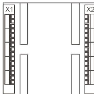
Клеммы прибора рассчитаны на подключение проводов с максимальным сечением не более 2,5 мм<sup>2</sup>.
