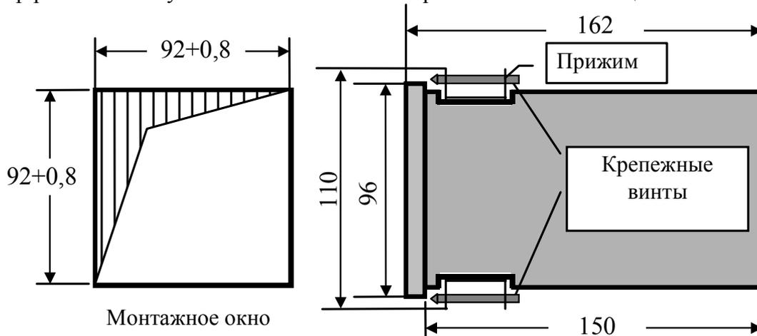
Крепление прибора осуществляется двумя прижимами, которые с помощью крепежных винтов прижимают обечайку корпуса к наружной стороне щита.
