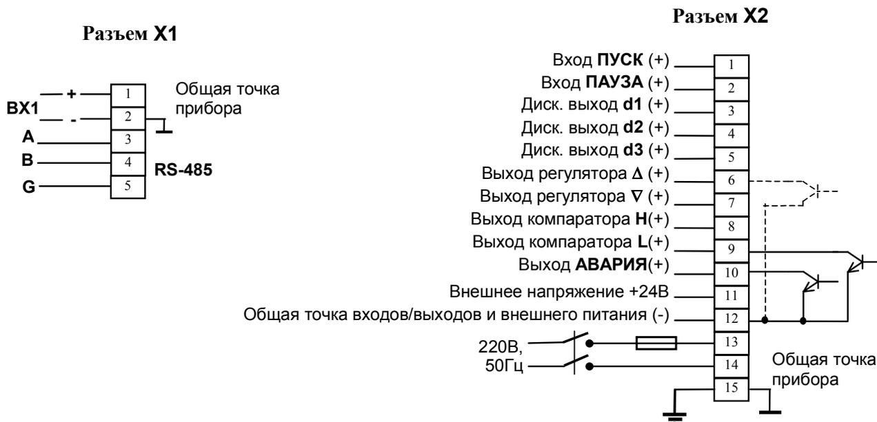
Рисунок 4.1 - Схемы подключения к клеммным соединителям прибора
