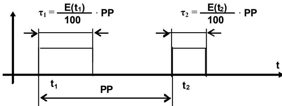
Рисунок 3.3 - Временная диаграмма сигналов управления ШИМ-модуляторов
