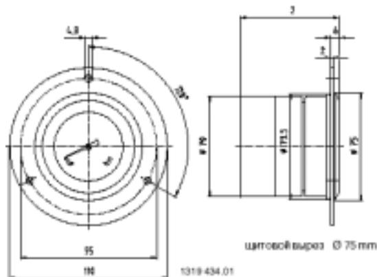
**Вариант** Крепежный фланец сзади
