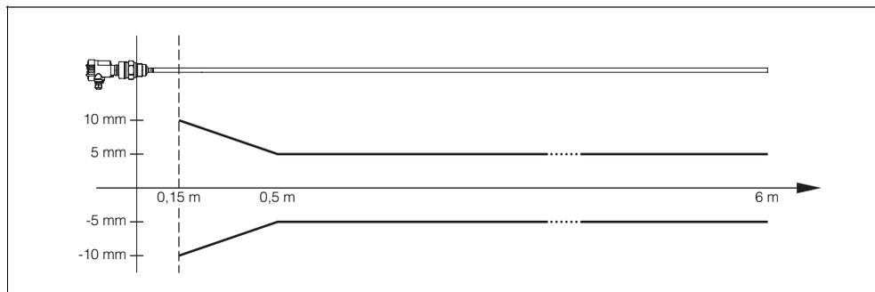
Рис. 25: Точность KSR-GT 622 в исполнении со стержнем
