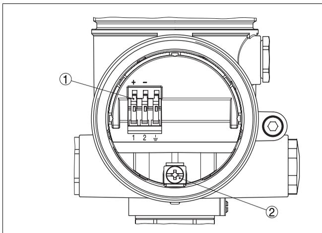
Рис. 18: Отсек подключения в двухкамерном корпусе Exd
