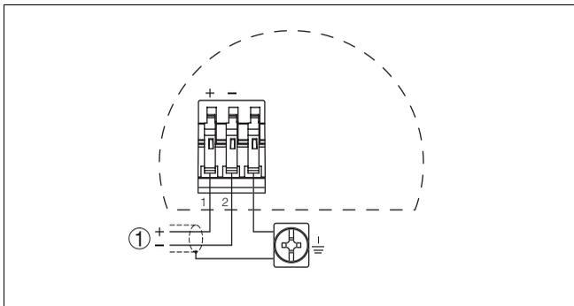
Рис. 19: Схема подключения для двухкамерного корпуса Exd
