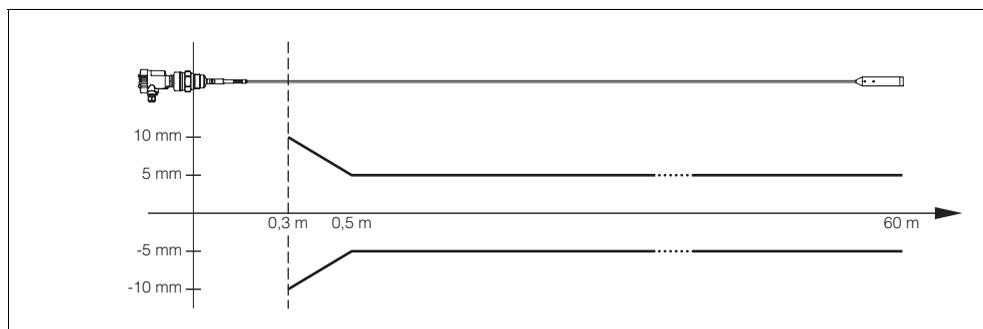
Рис. 26: Точность KSR-GT 622 в исполнении с тросом
