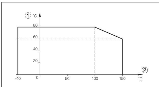
Рис. 27: Температура окружающей среды - температура продукта
