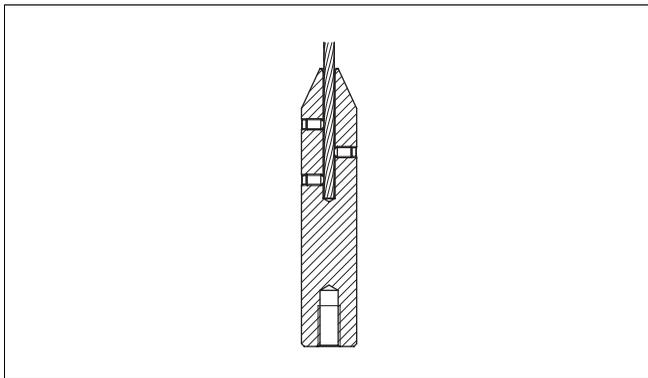
Рис. 23: Укорачивание измерительного троса
