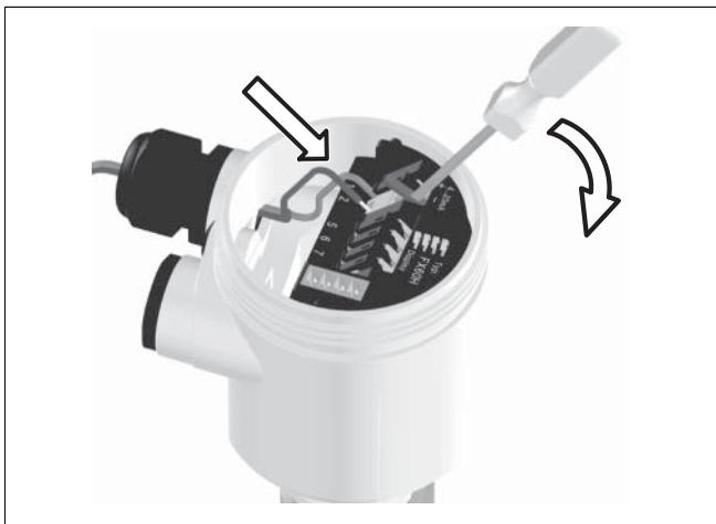
Рис. 8: Подключение к источнику питания: шаги 6 и 7
