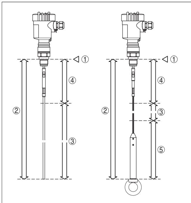
Рис. 24: Диапазон измерения KSR-GT 622
