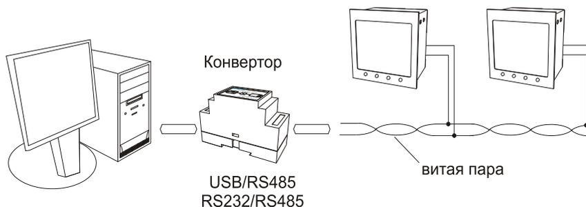
В приборе реализованы два протокола для работы с интерфейсами – протокол Modbus (ASCII) и протокол Термодат. Протокол Термодат упрощённый, использовался в ранних моделях приборов, оставлен в новых приборах для совместимости с прежним программным обеспечением. Мы рекомендуем использовать протокол Modbus.
