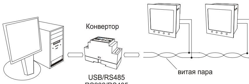
В приборе реализованы два протокола для работы с интерфейсами – протокол Modbus (ASCII) и протокол Термодат. Протокол Термодат упрощённый, использовался в ранних моделях приборов, оставлен в новых приборах для совместимости с прежним программным обеспечением. Мы рекомендуем использовать протокол Modbus.
