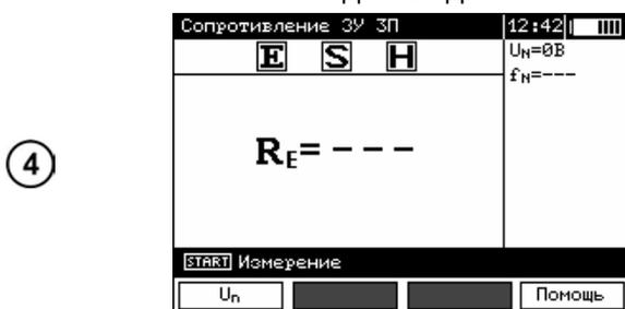
На дополнительной части дисплея отображаются значения напряжения шума и частота. В строке настроек отображается значение частоты, установленное в Меню прибора.
