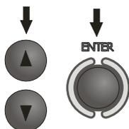
Используя клавиши ▲ и ▼, установите необходимое значение измерительного напряжения и нажмите **ENTER**.
