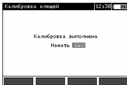
Измеритель определяет калибровочный коэффициент для подключенных клещей. Данный коэффициент хранится в памяти измерителя до тех пор, пока не будет произведена следующая калибровка.
