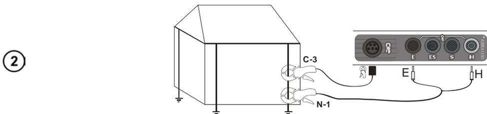
Подключите передающие клещи к разъемам **H** и **E**, при этом измерительные клещи должны быть подключены к стандартному разъему.
