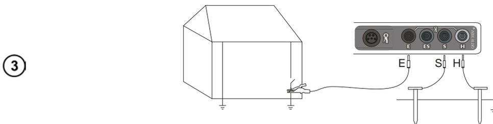
Установите токовый зонд и подключите к разъему **H** измерителя.
