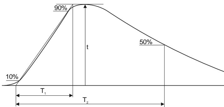
Форма сигнала зависит от отношения  $T_1/T_2$  (например, 10/350мкс)
