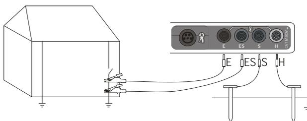
Установите токовый зонд и подключите к разъему **H** измерителя.
