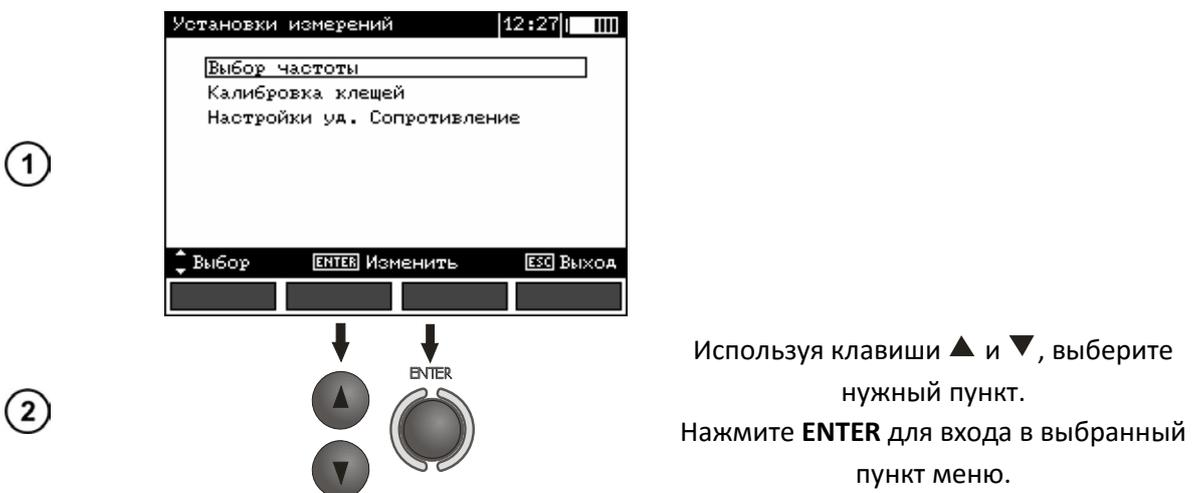
Необходимо определить частоту измерительного сигнала для компенсации возможных помех. Только те измерения, которые основаны на правильном выборе частоты измерительного сигнала,
