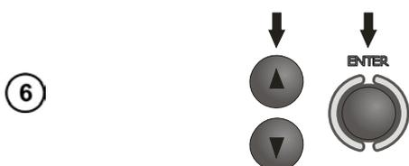
Используя клавиши **▲** и **▼**, установите необходимое значение измерительного напряжения и нажмите **ENTER**.
