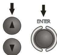
Используя клавиши ▲ и ▼, установите расстояние между измерительными зондами и нажмите **ENTER** для начала измерения.
