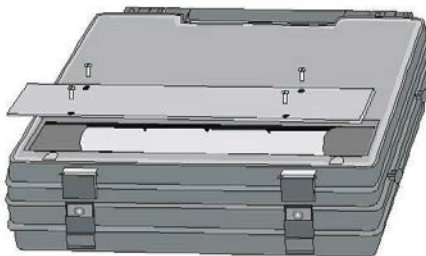
Способ вскрытия контейнера для аккумуляторов
