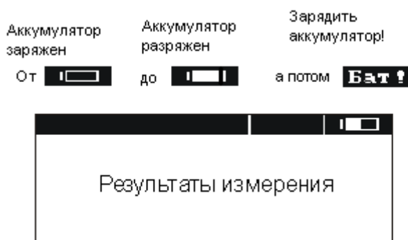
Контроль состояния зарядки аккумуляторов
