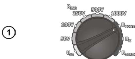
Установите поворотный переключатель в режим  $R_{\text{CONT}}$
