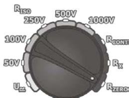
Установите поворотный переключатель в режим  $R_{ZERO}$
