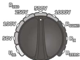
Установите поворотный переключатель в режим  $R_{ISO}$  для одного из стандартных напряжений.
