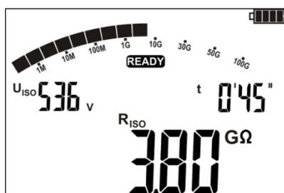
После окончания измерения на дисплее отобразится величина измерения сопротивления электроизоляции.
