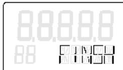
В 1-й строке дополнительно отображается ход в мм, если установленная длина рычага была указана с помощью параметра "3.YWAY".
