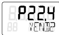
Теперь переместите привод с помощью клавиши  $\triangle+$ - и  $\triangle-$ - в положение, которое вы хотите определить как второе конечное положение. Затем нажмите  $\square$ -клавишу. При этом текущее положение записывается как конечное положение 2.
