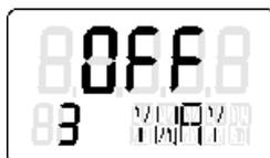
Этот параметр нужно настраивать только в том случае, если в конце инициализации должен отображаться полный ход в мм. Для этого выберите на индикаторе то же значение, на которое вы настроили поводковый штифт на шкале на рычаге.
