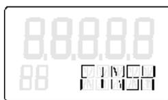
В 1-й строке дополнительно отображается ход в миллиметрах, если установленная длина рычага была указана с помощью параметра "3.YWAY".
