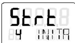
Во время инициализации на нижнем индикаторе последовательно появляются надписи от "RUN1" до "RUN5". В зависимости от привода процесс инициализации может длиться до 15 минут и завершается при появлении следующего изображения:
