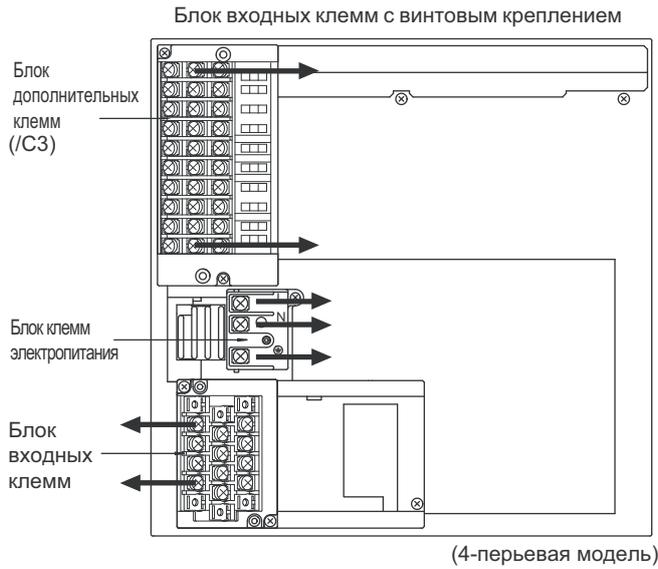
Примечание: Стрелки показывают направление, куда будут выходить провода при подключении к клеммам.
