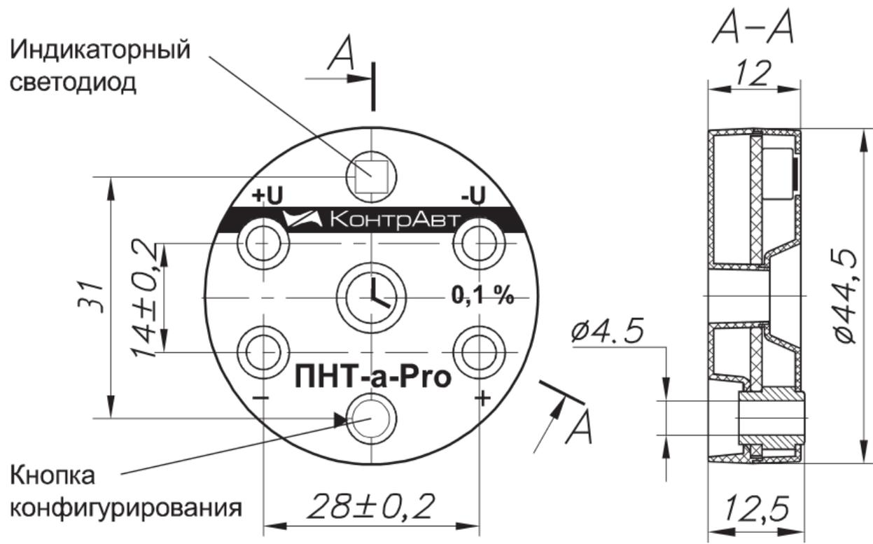
Рисунок 1 – Внешний вид и габаритные размеры преобразователя
