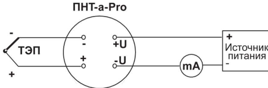
Рисунок 2 – Схема подключения преобразователя для работы с термопарой
