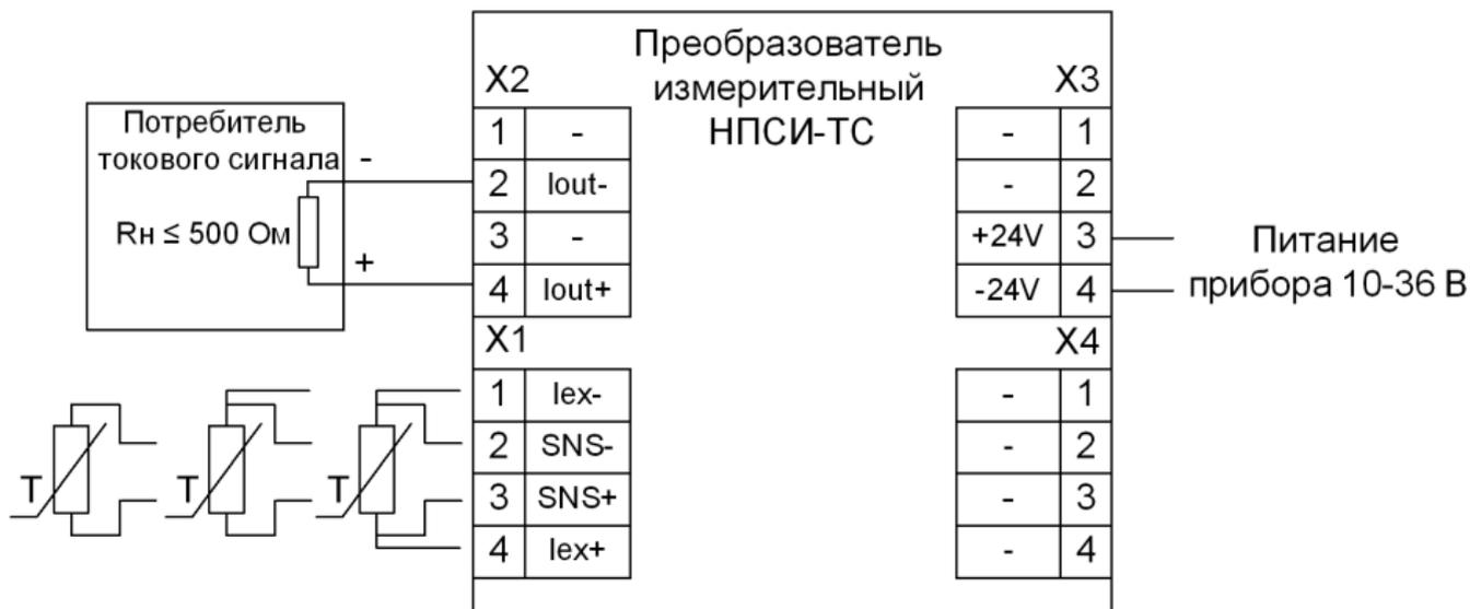
Рисунок 4 – Электрическая схема подключения преобразователя НПСИ-ТС-I-24-X
