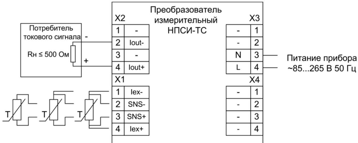
Рисунок 3 – Электрическая схема подключения преобразователя НПСИ-ТС-I-220-Х
