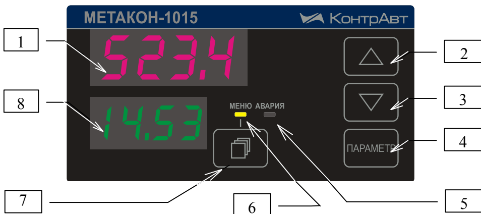
Рисунок 1 - Передняя панель прибора МЕТАКОН-1015
