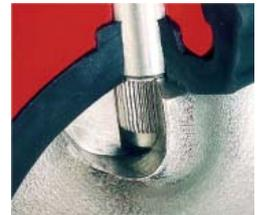
Посадка с натягом обеспечивает надежную фиксацию цапфы в корпусе
