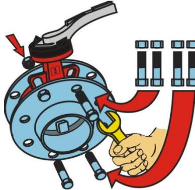
3. С помощью четырех винтов слегка привернуть, сравнить положение клапана.
