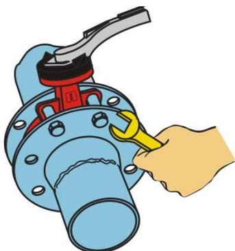
7. Клапан центрировать и слегка привернуть с помощью четырех винтов.
