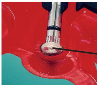
Посадка с натягом обеспечивает надежную фиксацию цапфы в корпусе
